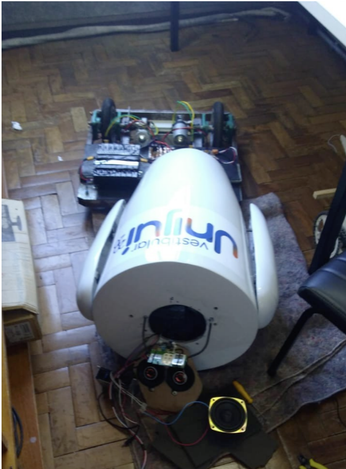
Figura 38 – Robô sendo desmontado para receber os novos circuitos de fala.
